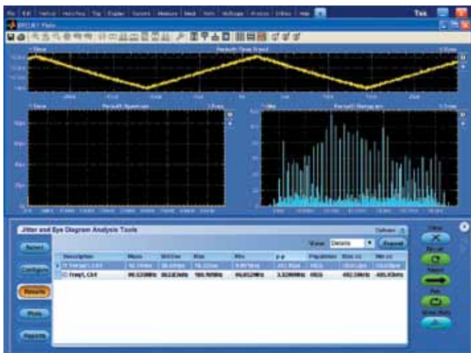
Расширенный анализ, измерения джиттера, временных характеристик и глазковой диаграммы.
